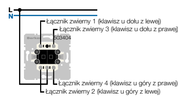
Przycisk seryjny, 2 styki zmienne, oddzielne zaciski wejściowe [Nr kat. 53 5038 08] / łącznik seryjny grupowy, 4 styki zwierny, wspólny zacisk wejściowy [Nr kat. 53 5034 04]
